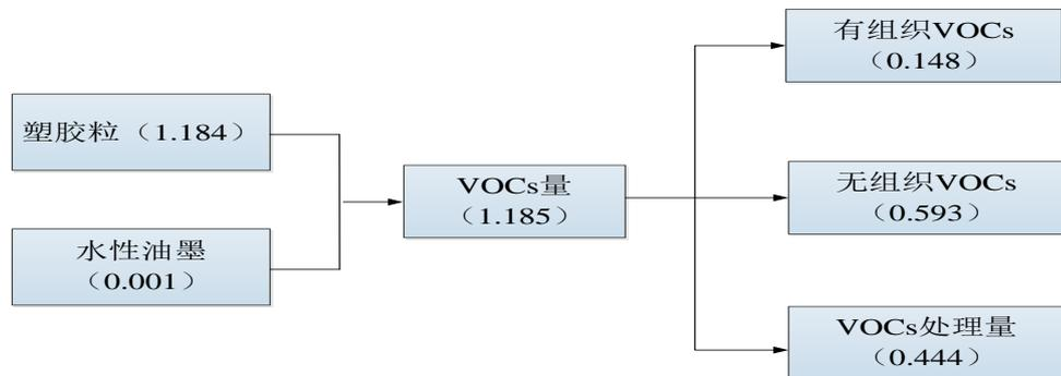
图 2-2 项目 VOCs 平衡图 单位：t/a
