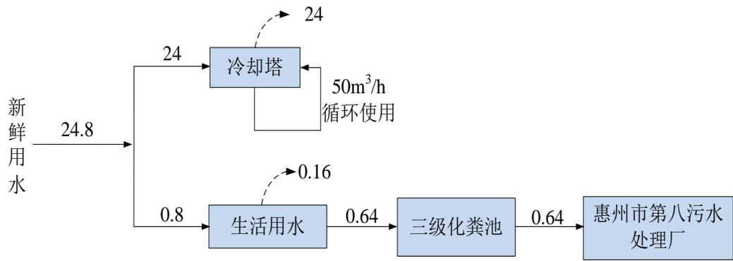
图2-1 项目水平衡示意图 单位：m<sup>3</sup>/d
