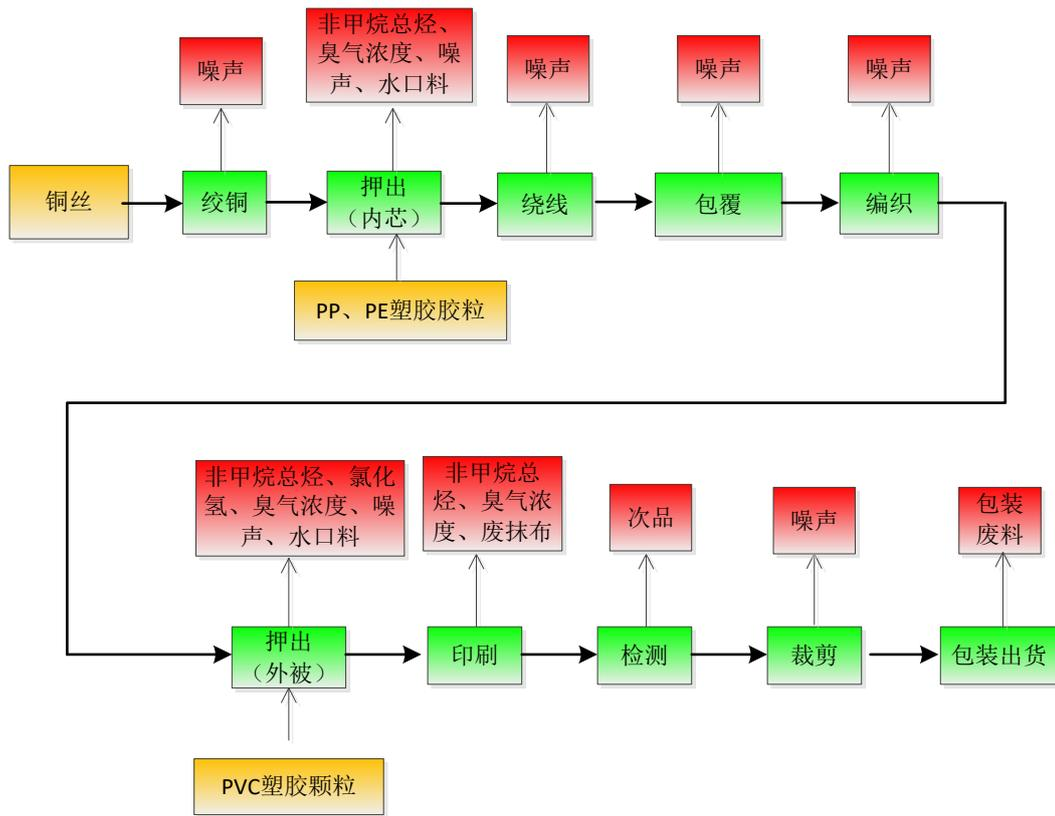
图 2-3 数据线生产工艺流程及产污环节图
