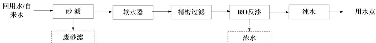
图 2-8 纯水制备工艺流程及产污环节图
