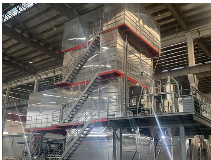
图 4-1 项目吹膜设备密闭隔间参考图
