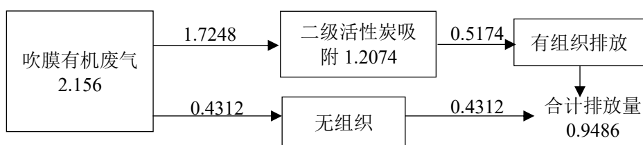
图2-2项目VOCs平衡图 (单位: t/a)
