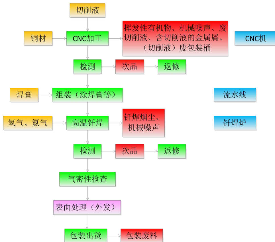
图 2-4 现有项目散热器水冷板工艺流程及产污环节分析图
