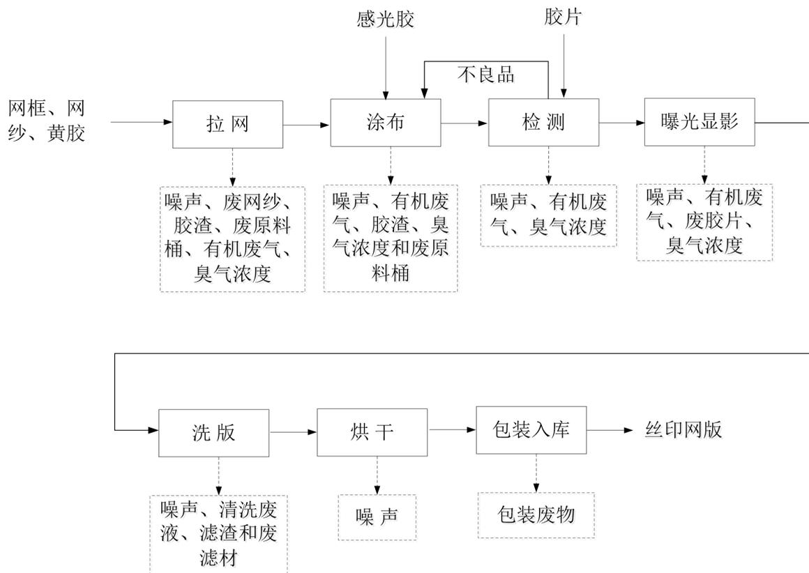
图 2-6 项目制版生产工艺流程及产污环节分析示意图
