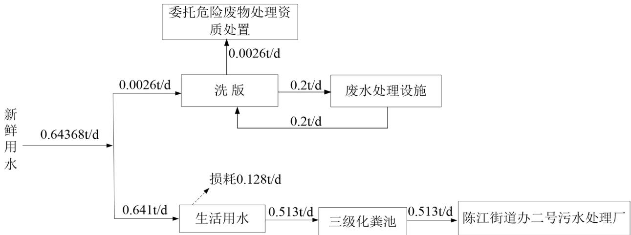
图2-1 项目水平衡图
