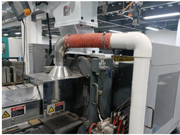
图 4-1 注塑废气半密闭型集气设备参考示意图
