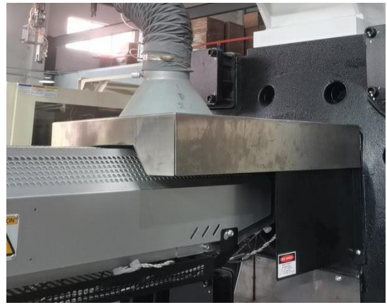
图 4-1 注塑废气半密闭型集气设备参考示意图
