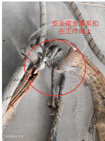
图 6：安全短绳的金属系扣挂在工作绳上（随人坠落）
