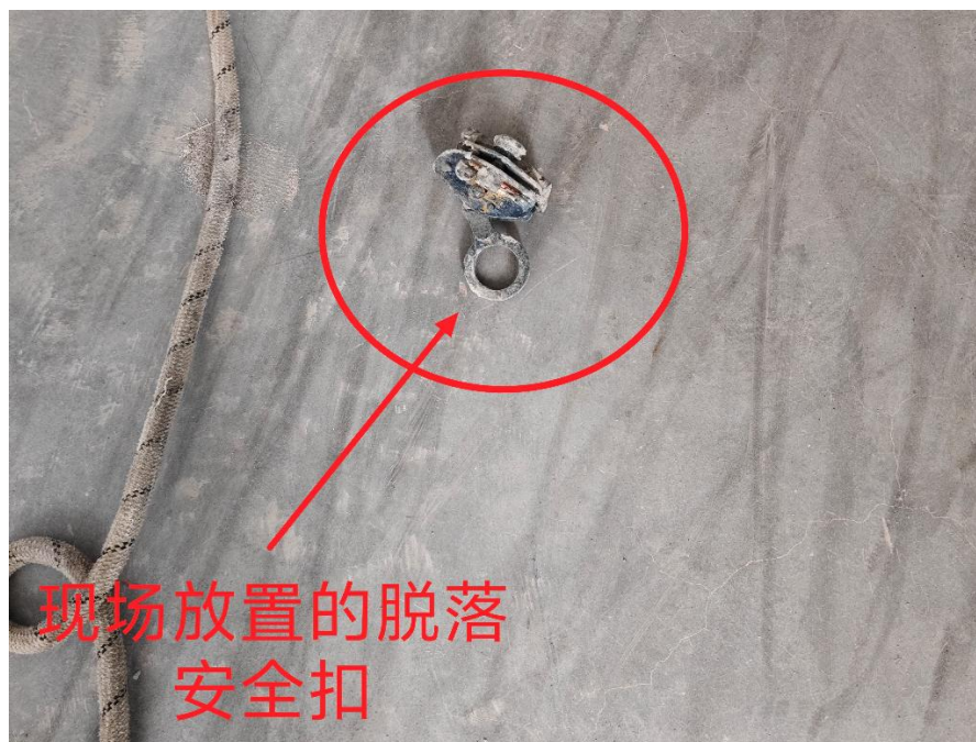
图 7：房间内放置的脱落安全扣（自锁器，随人坠落）
