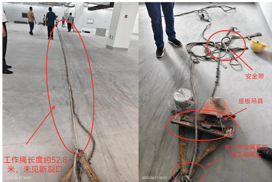
图 5: 工作绳长度约 52.8 米（未见断裂口）以及毛某所用器具
