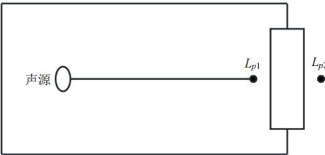
图 4-1 室内声源等效为室外声源图例
